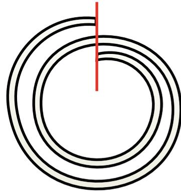
Papier so doppelt rollen, das weder eine ein- noch dreifache Überlappung am Zylinder entsteht
