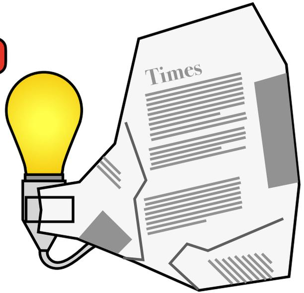
Zeitungsblatt mit Klebestreifen an Fassung befestigen und gleichmäßig zu einer Kugel um die Fassung wickeln
